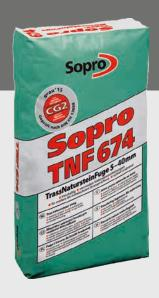
Zementärer, trasshaltiger und schnell erhärtender Fugenmörtel für mittel- bis mittelschwer beanspruchte Pflaster- und Natursteinbeläge. CG2 nach DIN EN 13 888. Chromatarm gemäß EG-Richtlinie 2003/53/EG.
